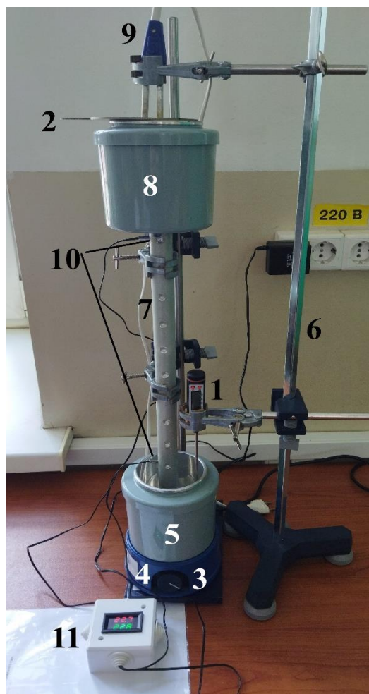
Рис. 3. Экспериментальная установка для определения теплопроводности металла: 1 – термометр; 2 – крышка для верхнего калориметра; 3 – подставка; 4 – магнитная мешалка; 5 – нижний калориметр; 6 – штатив; 7 – исследуемый металлический стержень; 8 – верхний калориметр; 9 – нагреватель (кипятильник); 10 – контактные термодатчики; 11 – прибор для измерения температуры
