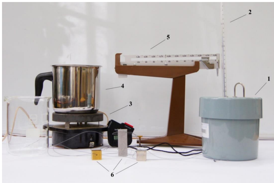
Рис.3. Схема установки для проведения измерений по определению удельной теплоемкости металлов
