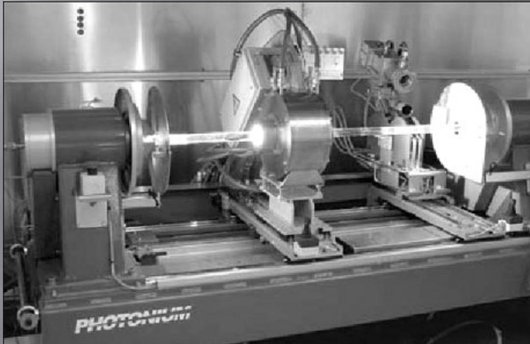
Развитием этого метода является метод PCVD (Plasma -activated Chemical Vapor Deposition), в котором разогрев трубки производится токами высокой частоты.
