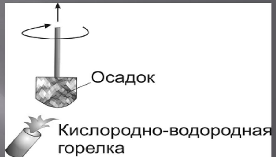
Метод внешнего парофазного осаждения (Outside Vapor Deposition - OVD) - осаждение двуокиси кремния с примесями происходит на внешней поверхности стержня. По окончании процесса исходный стержень извлекается, а заготовка схлопывается.
