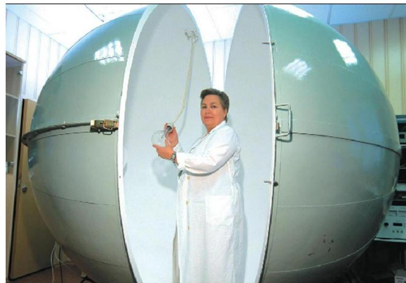
Фотометрический шар диаметром 2 метра для поверки светоизмерительных ламп и для измерения светового потока источников света
