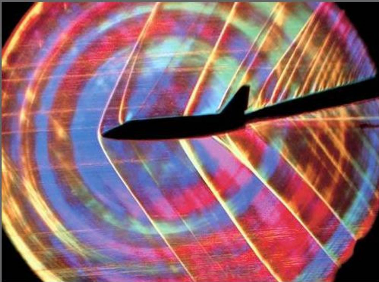
Космический шаттл: сверхзвуковая аэродинамика. Продувка модели космического челнока в трубе показывает разработчикам зоны образования ударных волн
