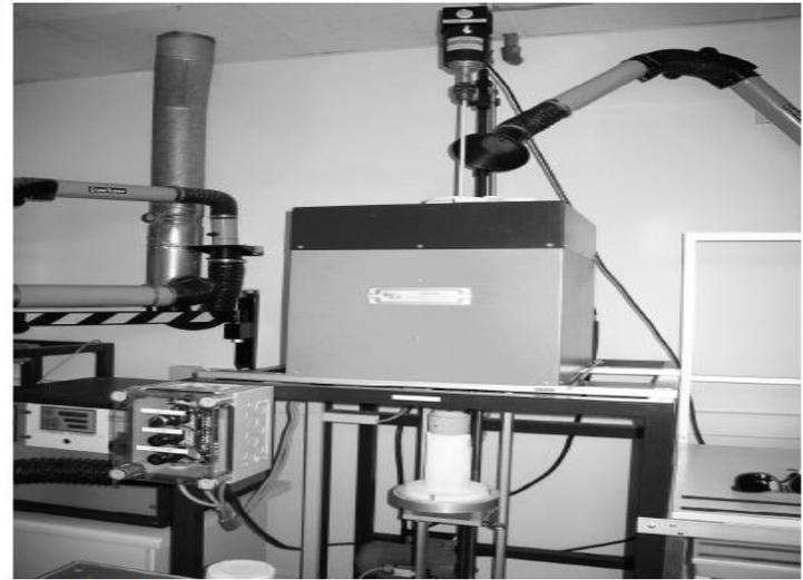
Общий вид установки для лабораторной варки стекол
