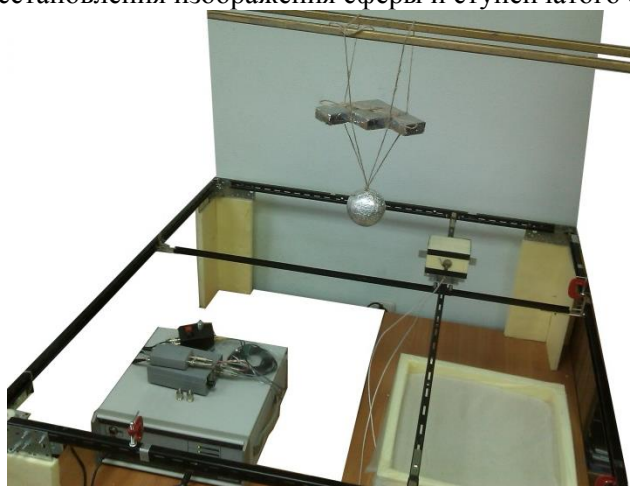
Рис. 6. Фотография экспериментальной установки для проверки возможности визуализации при частичном затенении
