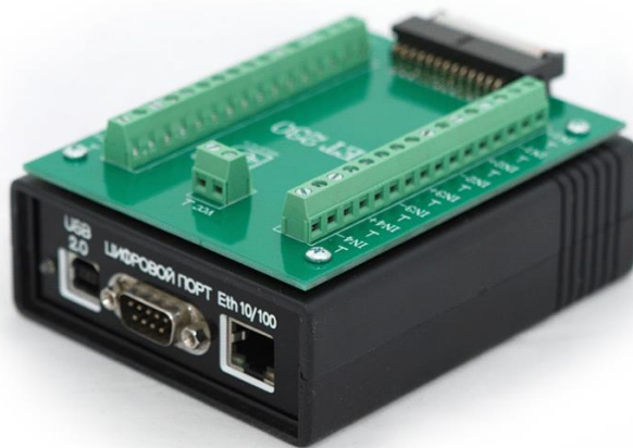
Рис.1. Плата АЦП/ЦАП ZET 230
