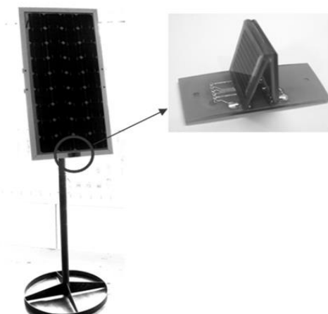
Рис. 7. Экспериментальный макет системы слежения
