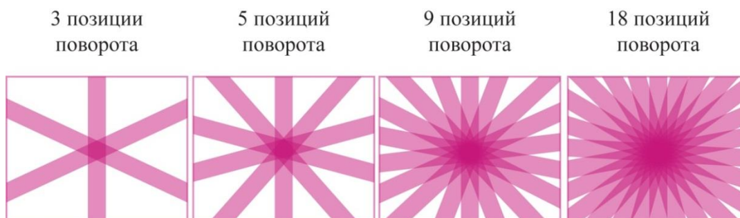
Рис. 4. Реконструкция точечного объекта при различном числе смещений
