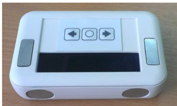
Рис. 1. Расположение электродов в корпусе
