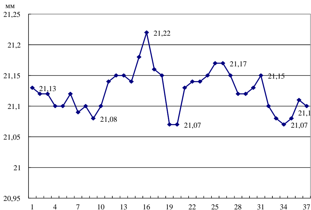
Рис.6. Экспериментальным путем измерения внутреннего диаметра трубы 21 мм
