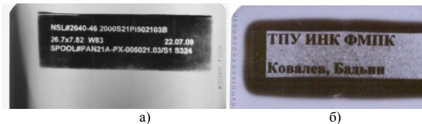
Рис.7. Маркировка нанесенная при помощи засвечивания а) в негативе; б) в позитиве.
