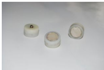
Рис 4. Нанoeлектроды с кнопочным отведением ЭСМГ-1/нЗ для электромиографии, электрокардиографии и измерения кожно-гальванической реакции
