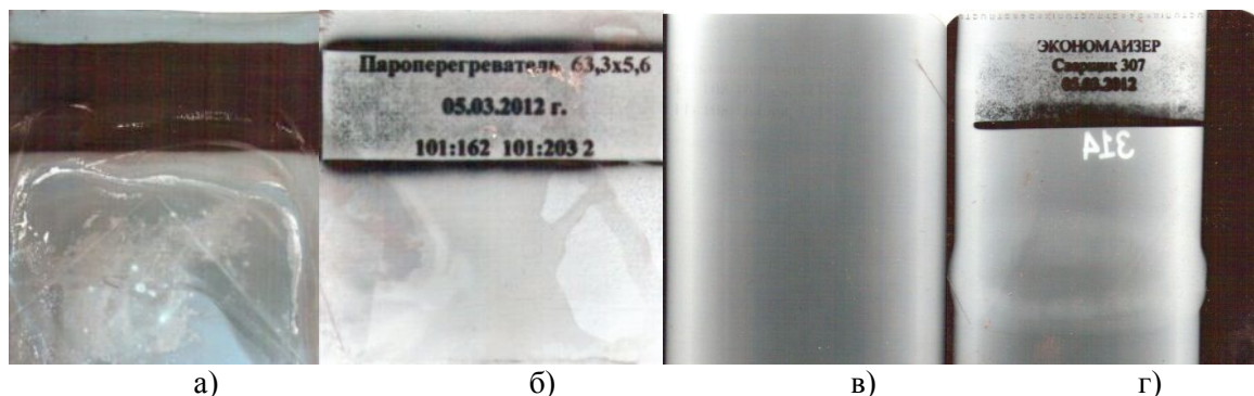
Рис.8. Маркировка пленки при различной яркости а) пленка AGFA NDT F8 при большой яркости; б) пленка AGFA NDT F8 при малой яркости; в) пленка AGFA NDT D4 при малой яркости; г) пленка AGFA NDT D4 при большой яркости.
