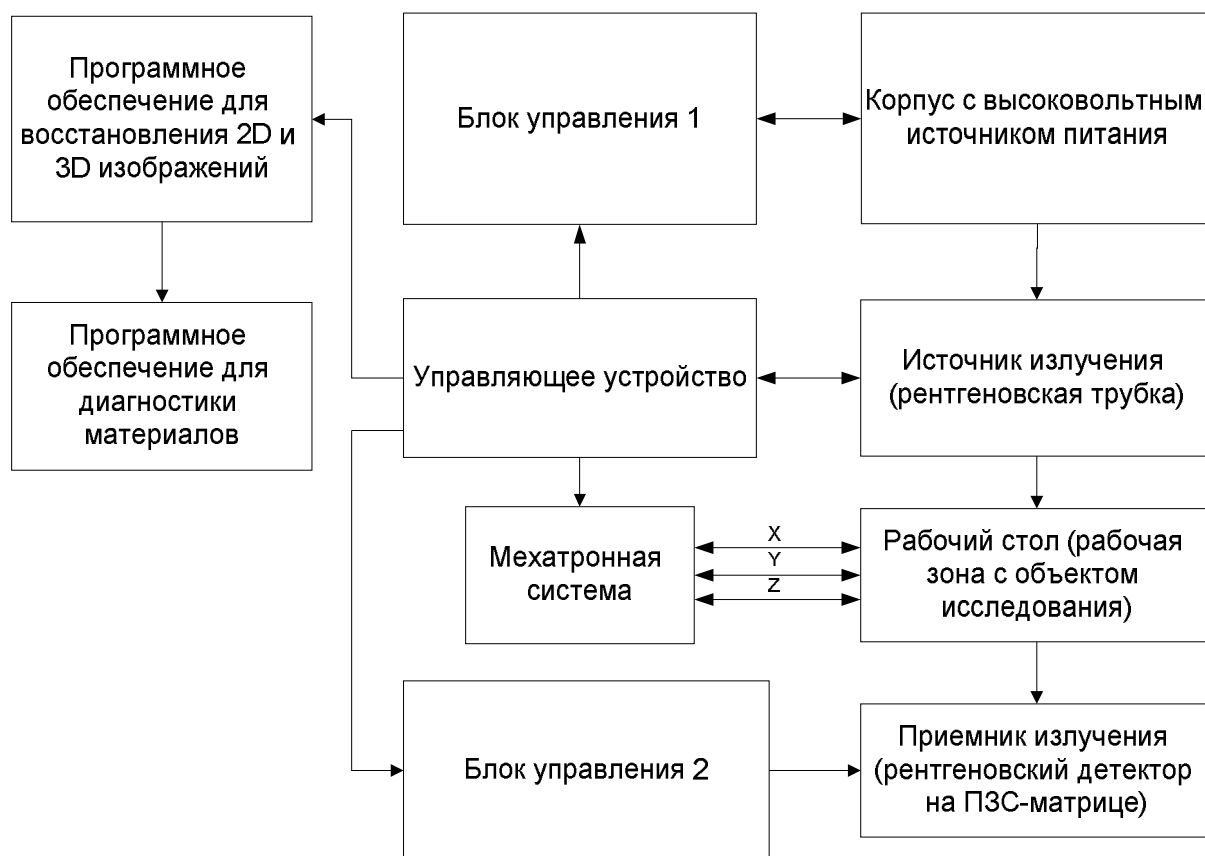
Рис. 2. Обобщенная схема рентгеновского микротомографа.
