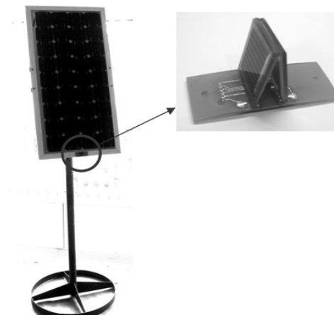
Рис. 10. Экспериментальный макет двухосевой системы слежения
