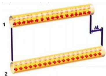
Рис. 2. Удлинение ферромагнитного стержня, помещенного в магнитное поле.
