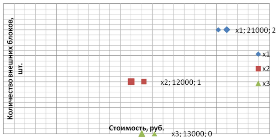
Рис. 4. Зависимость между стоимостью конечного прибора и количеством внешних блоков, использованных в нём.
