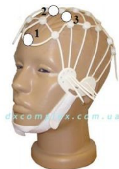
Рис 9. Крепление электродов для снятия ЭЭГ (1 – земля)
