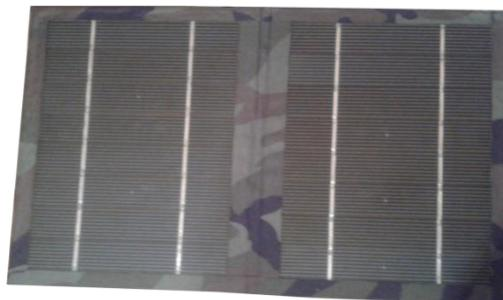
Рис. 2. Два фотоэлектрических модуля, соединенных последовательно
