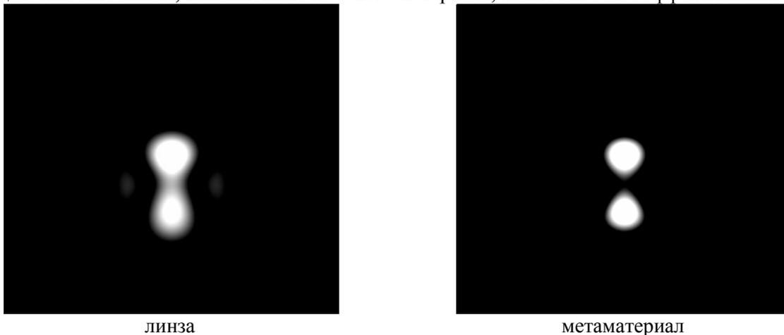
Рис. 5. Сравнение фокусировки собирающей линзой и метаматериалом.
