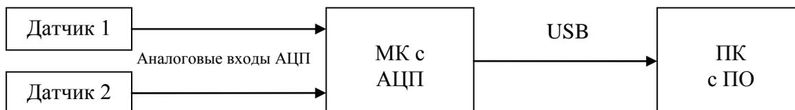
**Рис. 1.** Структурная схема предлагаемого устройства функциональной диагностики пищевода: Датчик 1, 2 – первичный преобразователь (при необходимости с преобразователем); МК с АЦП – микроконтроллер с двумя встроенными АЦП; ПК с ПО – персональный компьютер с установленным программным обеспечением
