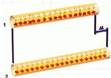
Рис. 2. Удлинение ферромагнитного стержня, помещенного в магнитное поле.
