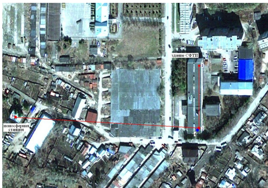
Рис. 1. Схема расположения на местности низкочастотных акустических датчиков (красными точками под номерами 1,2,3 обозначены микробарометры, синей точкой, под номером 4 обозначен микрофон).
