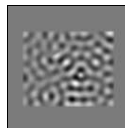
Рисунок 3 – Изображение звукового поля излучения пластины на частоте 60 кГц
