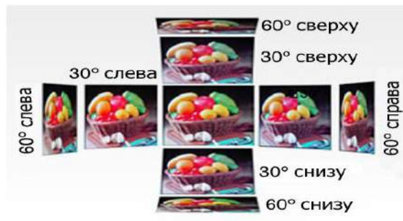
Рисунок 6 – Демонстрация углов обзора OLED дисплея.
