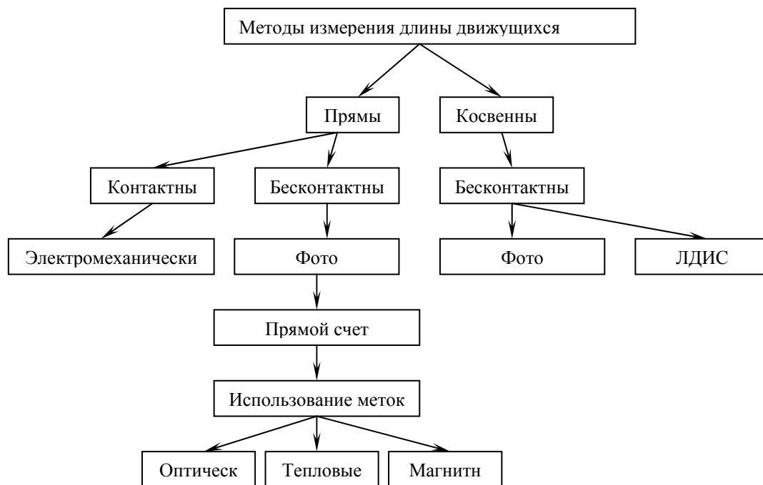
Рис. 3.1.1 Методы измерения длины протяжённых изделий.
