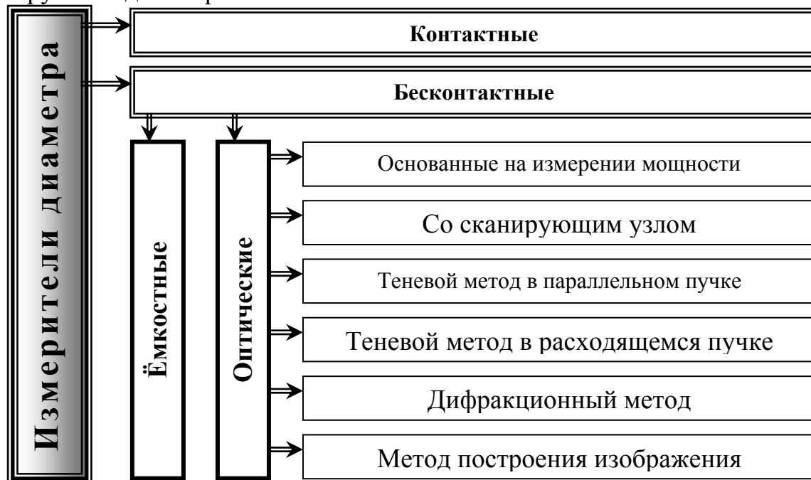
Рис 2.1.1 Классификация измерителей диаметра
