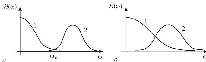
Рис. 6.1 Амплитудные спектры полезного сигнала (1) и помехи (2):
