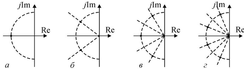
Рис. 6.7. Расположение полюсов фильтра Баттерворта:
