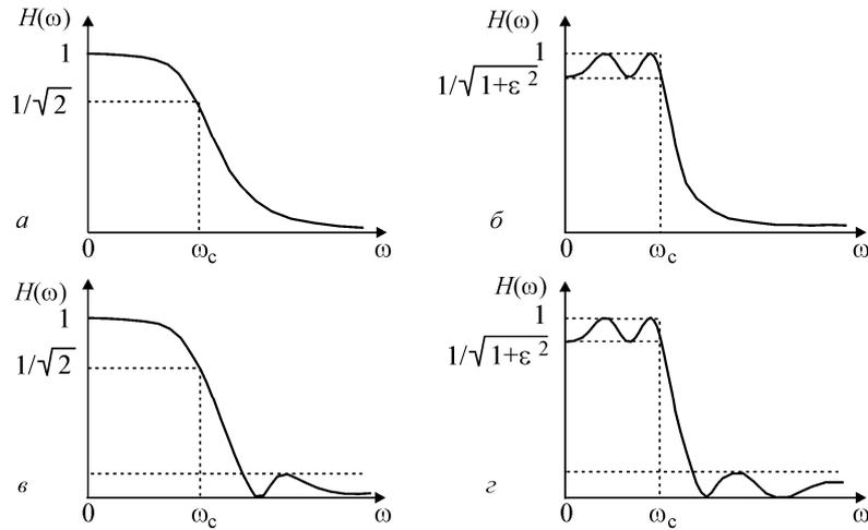
Рис. 6.5. Амплитудно-частотные характеристики типовых ФНЧ:
