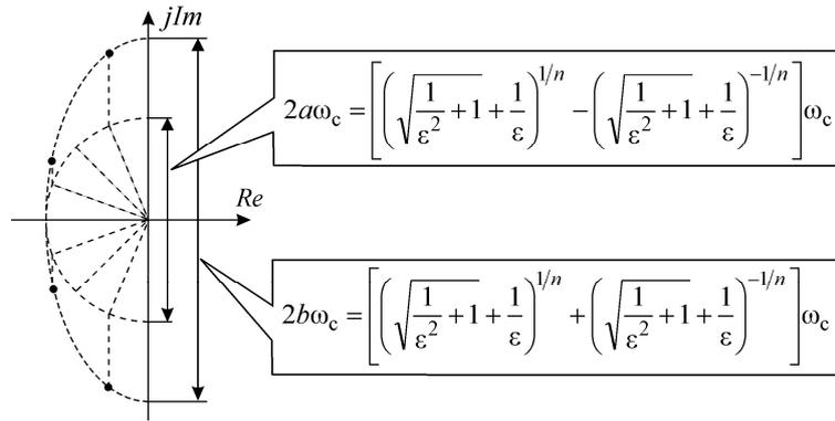
Рис.6.10. Расположение полюсов фильтра Чебышева первого типа ( $n = 4$ )
