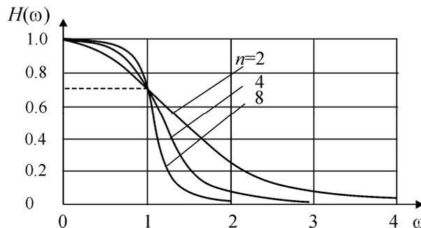
Рис 6.6. АЧХ фильтров Баттерворта различных порядков
