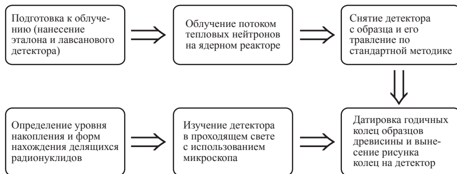
Рис. 4.15. Схема проведения работ при f -радиографических исследованиях образцов древесины
