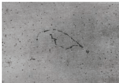
Рис. 3.6. Микроавторадиография бета-излучающего радионуклида. Эмульсия Ilford G5, \times 700 (по Э. Роджерсу, 1972). След движения \beta -частицы извилистый, точечный. Длину трека трудно определить. Можно только с уверенностью утверждать, что присутствует бета-излучатель
