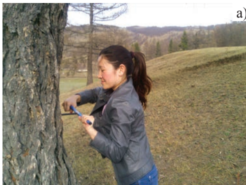
Рис. 6.1. Отбор керна из лиственницы буром (Mera Sweden) (а) и общий вид керна древесины (б)
