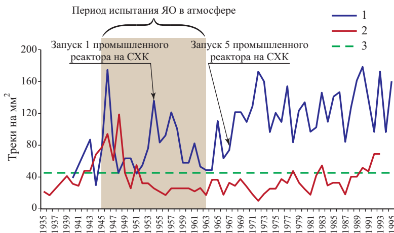
Рис. 5.24. Плотность треков от осколков деления U-235 и трансураниевых элементов в срезах деревьев Томской области, отобранных на разных удалениях от промышленного реактора: 1 – наблюдная кривая (5 км от реактора); 2 – наблюдная кривая (15 км от реактора); 3 – средний фон для Томского района (см. рис. 5.3)
