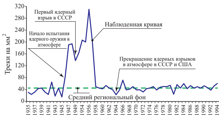
Рис. 5.3. Плотность треков от осколков деления U-235 и трансурановых элементов в срезе дерева (сосна) фоновой области Томской области: с. Ярское
