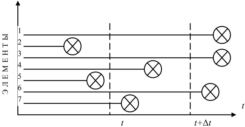
Рис. 2.2. Временная диаграмма отказов элементов
