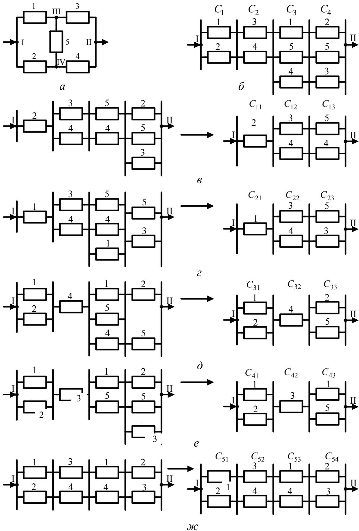
Рис. 4.11. Преобразования схемы по методу минимальных сечений
