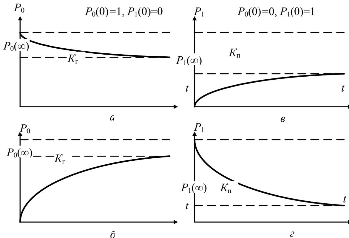
Рис. 4.2. Зависимости изменения вероятности безотказной работы и вероятности отказа одноэлементной схемы при различных начальных условиях
