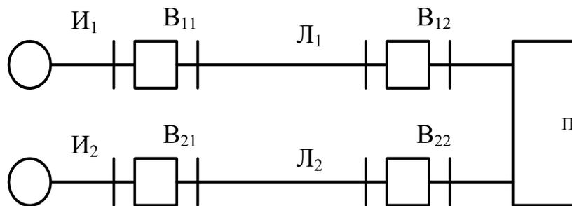
Рис. 4.4. Схема электроснабжения потребителя
