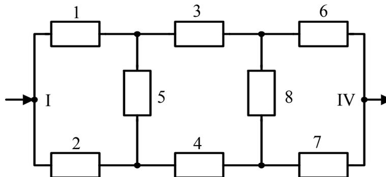
Рис. 4.7. Схема типа «двойной мостик»
