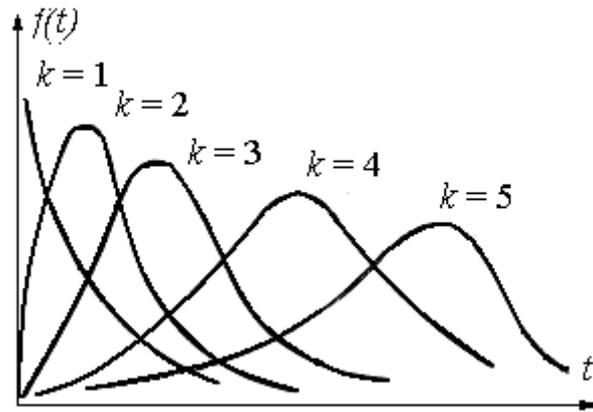
Рис. 3.17. Дифференциальная функция закона гамма-распределения времени безотказной работы при постепенных отказах
