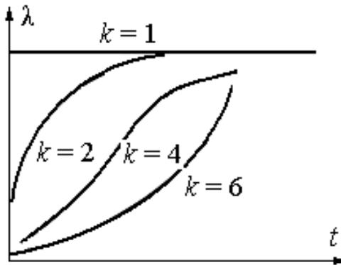
Рис. 3.18. Интенсивность отказов элемента при гамма-распределении времени безотказной работы
