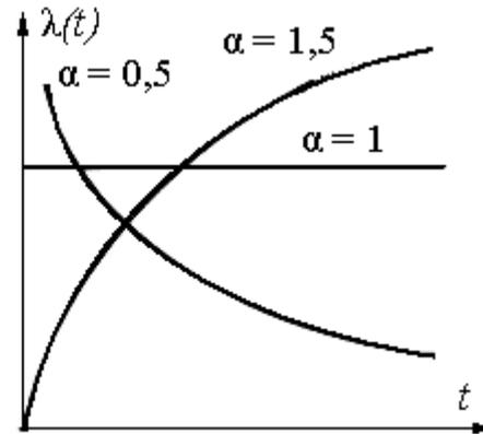
Рис. 3.22. Интенсивность отказов при распределении по закону Вейбулла
