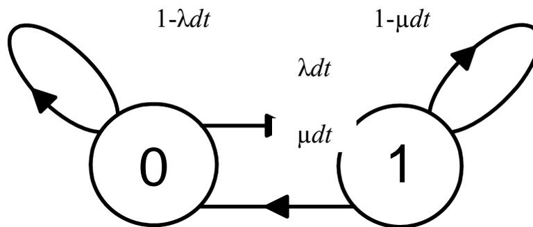
Рис. 4.1. Граф переходов для одноэлементной схемы
