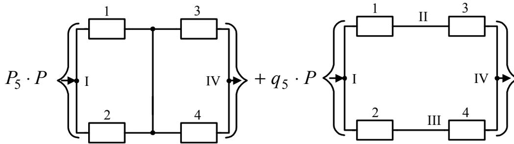
Рис. 4.6. Диаграмма, иллюстрирующая применение теоремы разложения для схемы типа «мостик»
