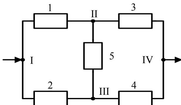
Рис. 4.5. Схема типа «мостик»
