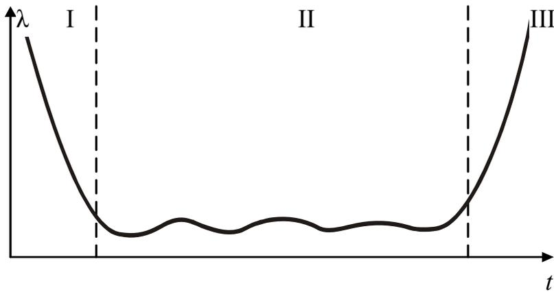
Рис. 2.3. Изменение интенсивности отказов элементов СЭС
