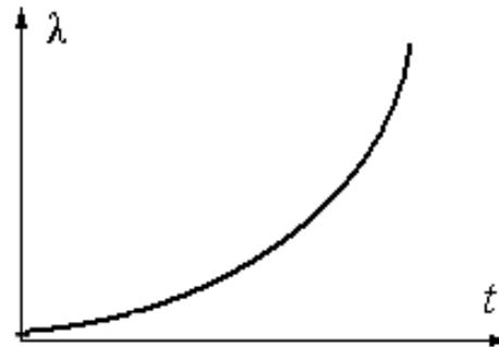
Рис. 3.19. Интенсивность отказов элемента при нормальном законе распределения времени безотказной работы элемента
