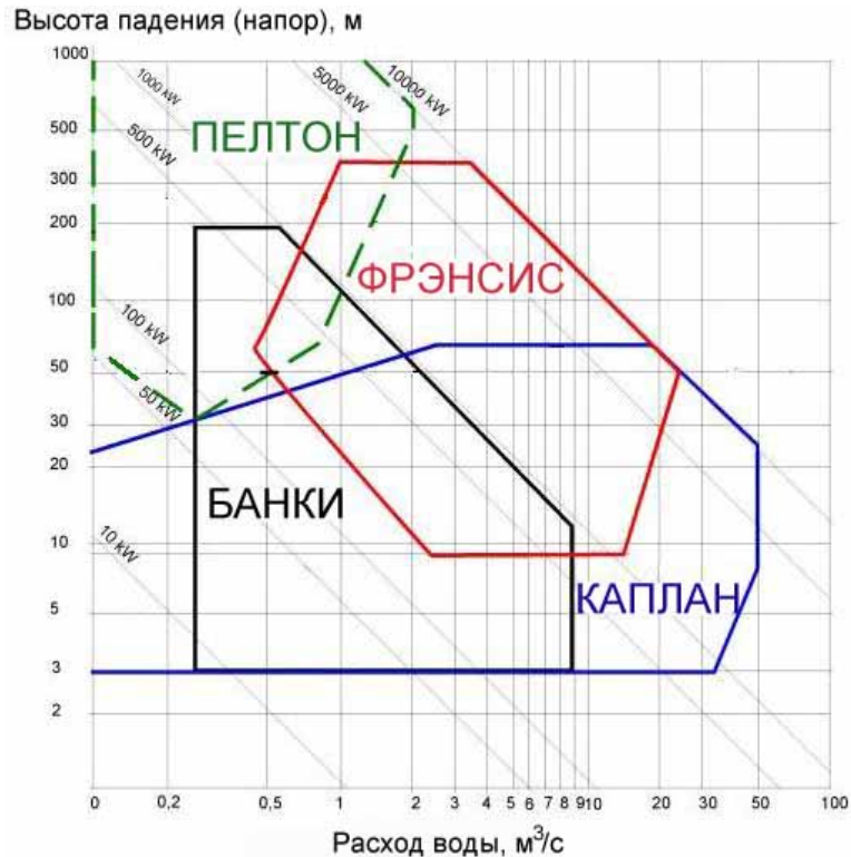
Рис.4.29. Зоны работы гидротурбин микроГЭС
