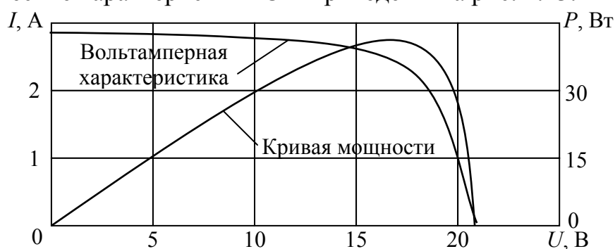
Рис.4.13 Вольтамперная характеристика солнечного модуля
