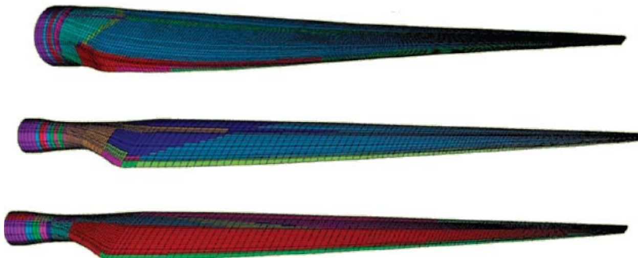
Рис.4.19 Профили лопастей ветроколес с горизонтальной осью вращения
