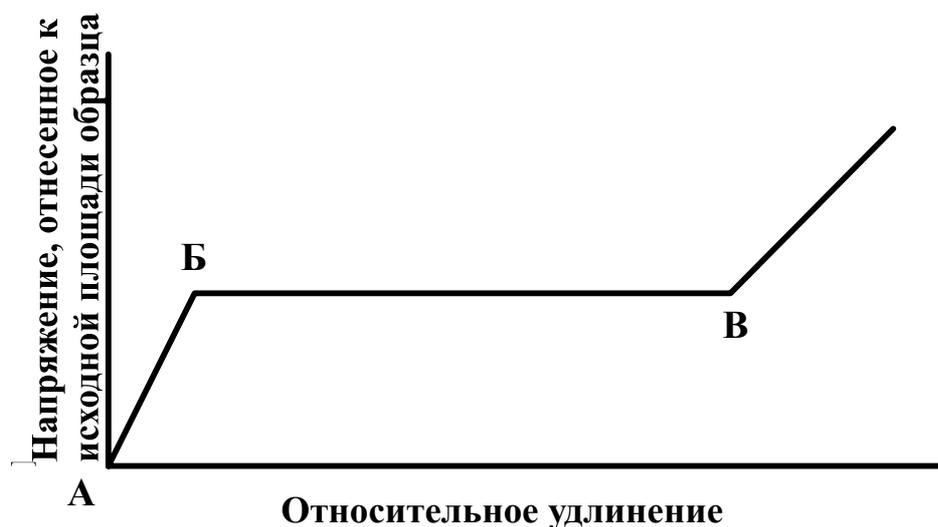
Рис. 1.7. Удлинение кристаллического полимера в зависимости от напряжения
