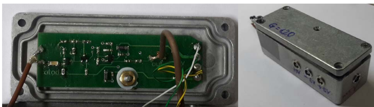
Рисунок 2.16 — Внешний вид усилителя, используемого в канале нейтронного счётчика, и его корпуса
