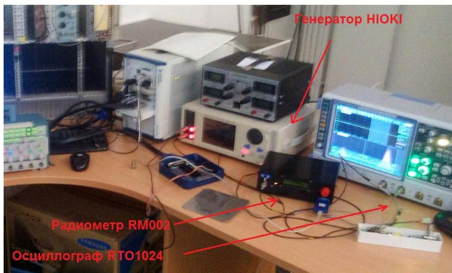
Рисунок 2.5 – Фотография лабораторного оборудования
