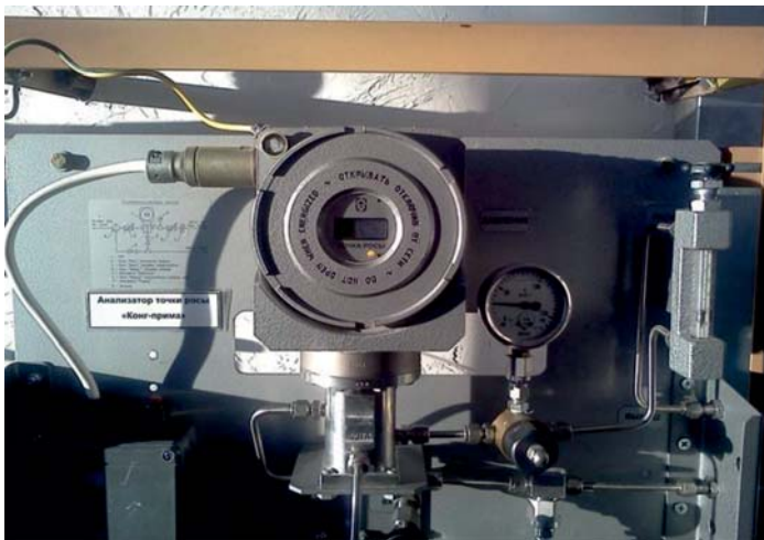
Рис. 4. Анализатор точки росы «КОНГ-Прима-10». Первичный прибор
