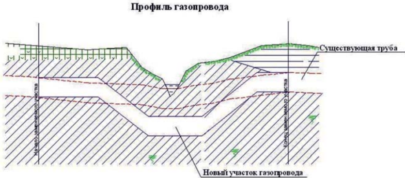
Рис. 3. Укладка газопровода методом «кривых вставок»
