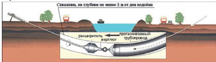
Рис. 2. Укладка газопровода способом наклонно-направленного бурения
