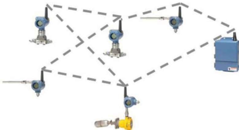
Рис. 1. Структура самоорганизующейся сети
