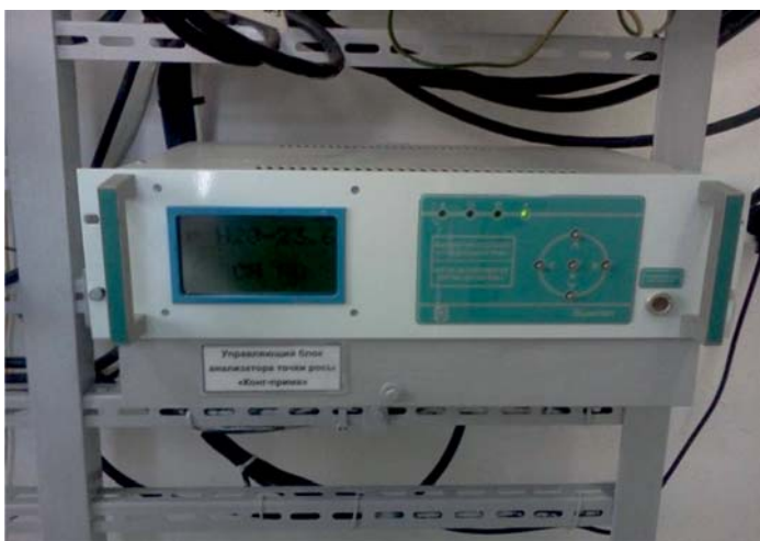
Рис. 5. Анализатор точки росы «КОНГ-Прима-10». Вторичный прибор
