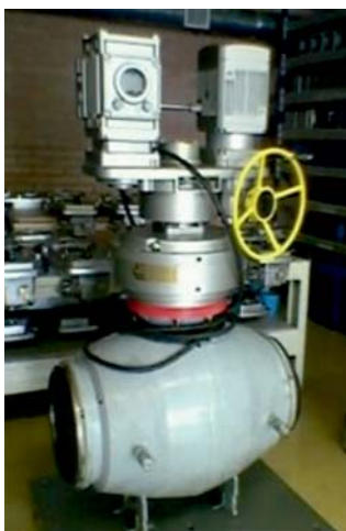
Рис. 4. Электропривод шарового крана DN=300 мм
