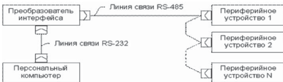
Рис. 6. Схема подключения устройств к RS 485 линии
