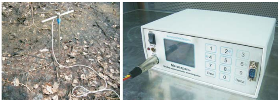
Рис. 3. Коррозионно-индикаторный зонд (А) и полярограф (Б)
