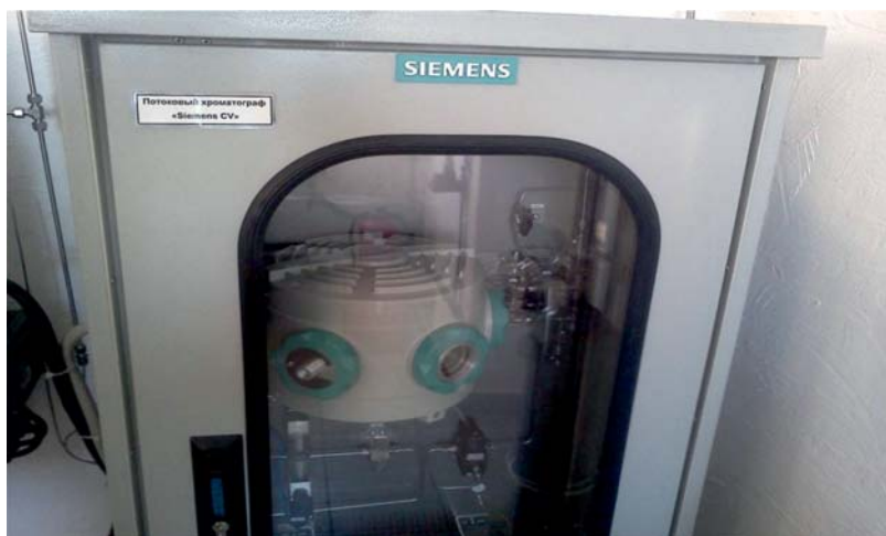
Рис. 3. Хроматограф MicroSam фирмы Siemens
