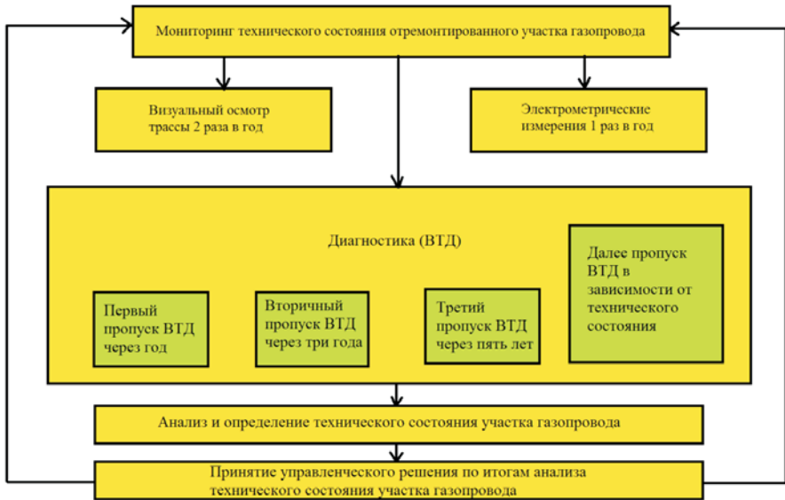
Рис. 1. Поддержание надежности и безопасности отремонтированного участка газопровода в процессе эксплуатации
