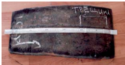
Рис. 1.1. Образец с трещиной участка газопровода
