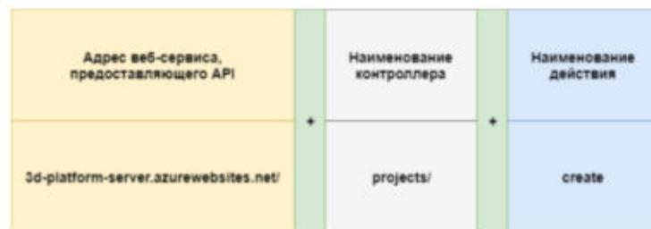
Рис. 4. Пример структуры POST-запроса
