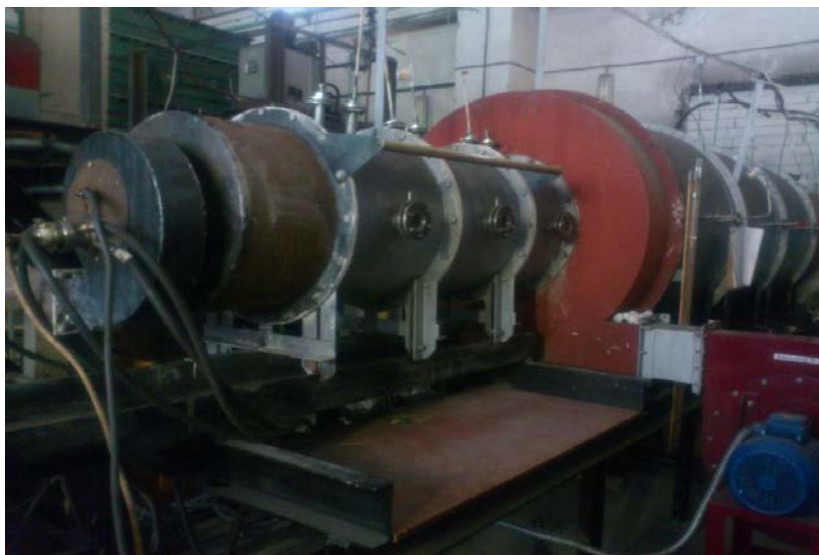
Рис. 2. Тепловой стенд ИТ СО РАН мощностью 5МВт с модернизированной вихревой горелкой и плазмотроном
