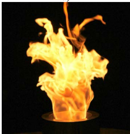
Рис. 1. Вид экспериментального стенда ИТ СО РАН номинальной мощностью порядка 50 кВт для исследования газозафазного горения (а) и визуализация пламени при диффузионном горении газообразного топлива - пропана (б). В рамках выполнения проекта стенд должен быть доукомплектован для проведения опытов с пылеугольным факелом
