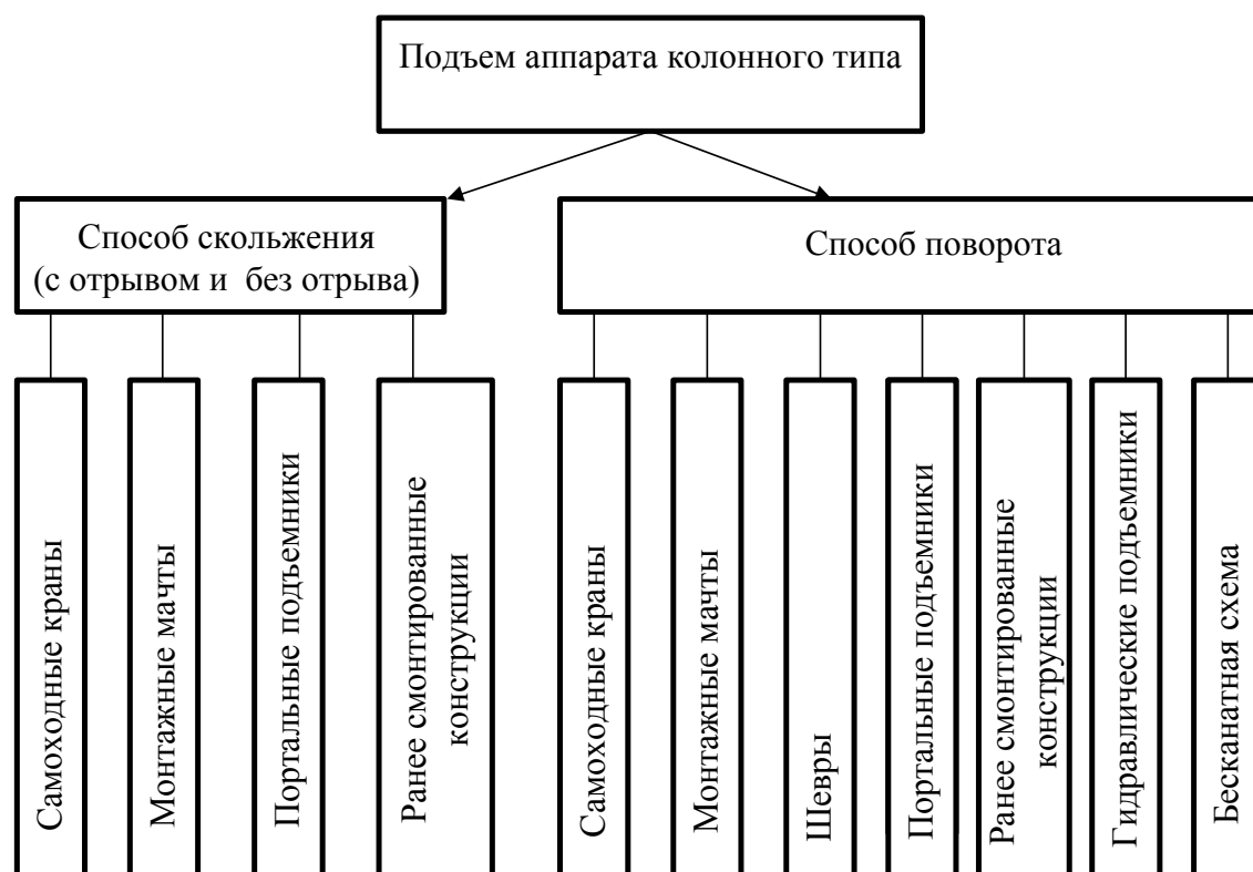
Рис. 3.1. Способы подъема аппарата различными грузоподъемными механизмами
