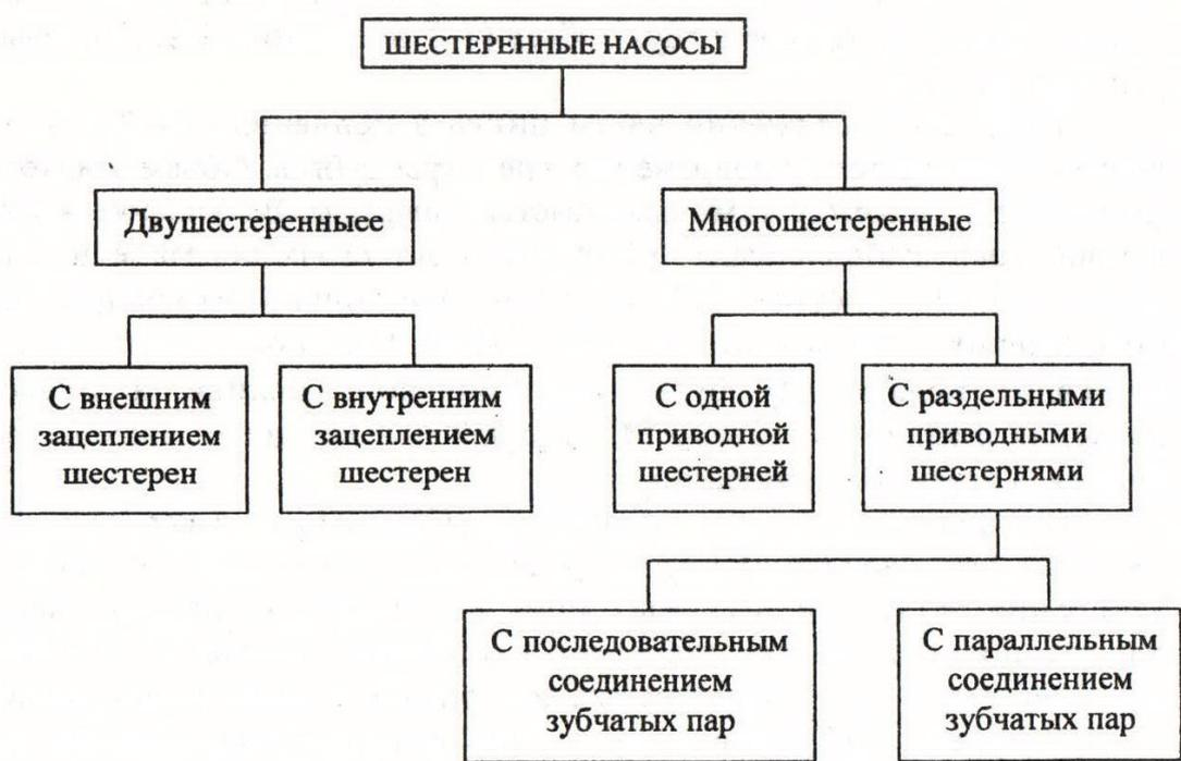
Рис. 1. 3. Классификация шестеренных насосов
