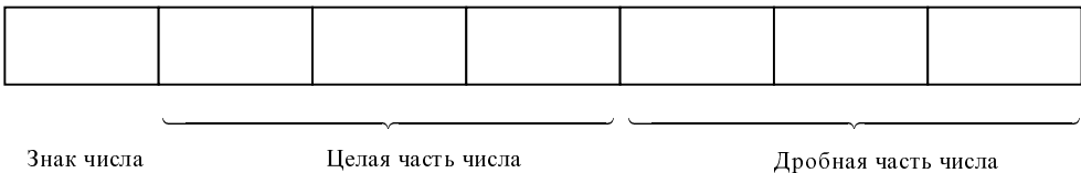
Рис. 1.1.2. Схема машинного слова запоминающего устройства с фиксированной запятой
