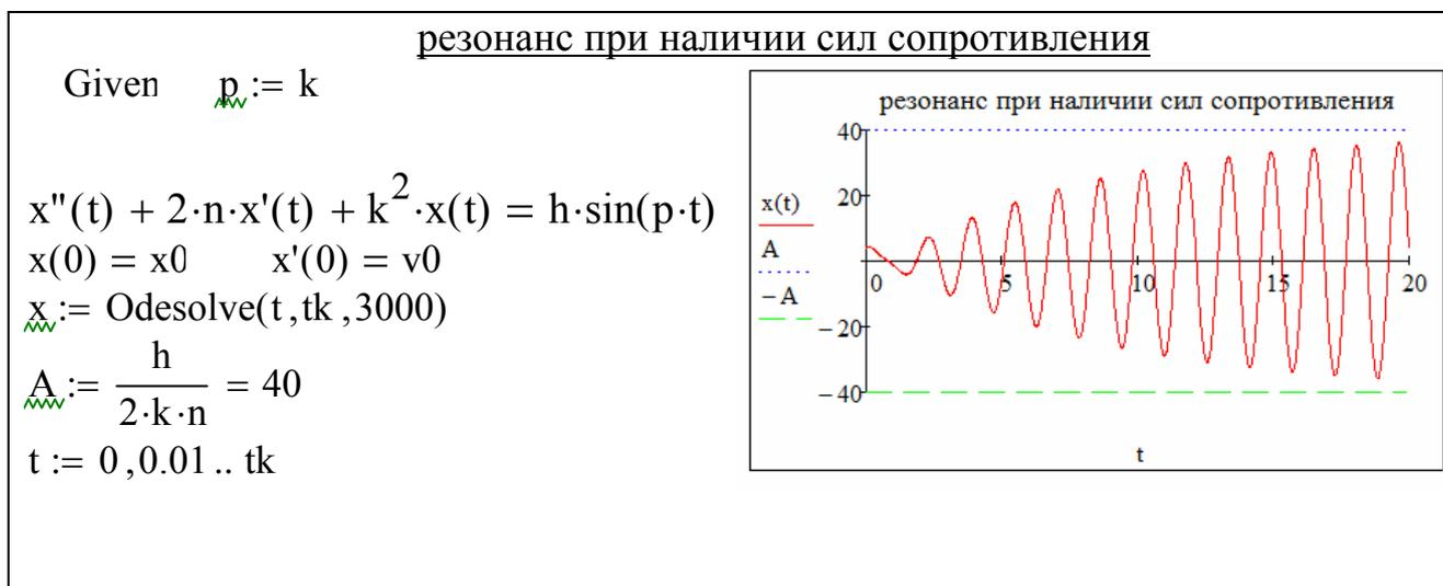
Рис. 3.37. Решение задачи о резонансе при наличии сил сопротивления
