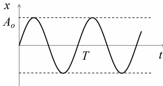
Рис. 3.22. График зависимости смещения точки, совершающей гармонические колебания, от времени
