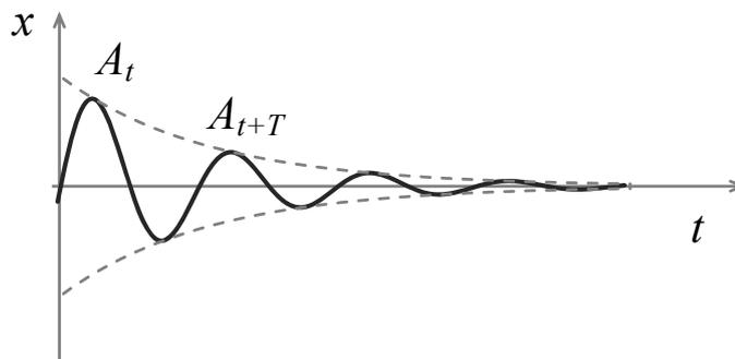
Рис. 3.24. График зависимости координаты точки, совершающей затухающие колебания, от времени
