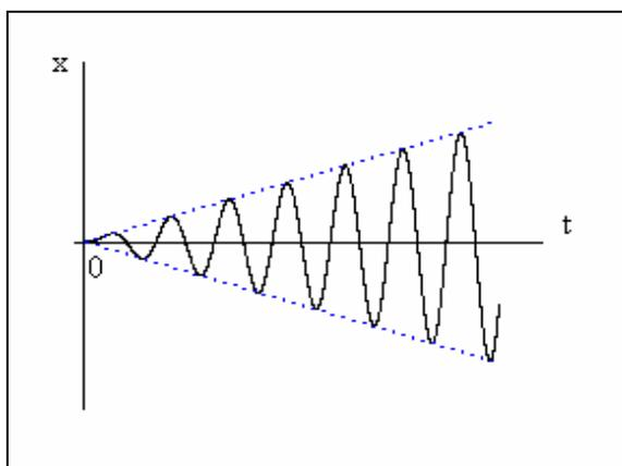
Рис. 3.28. График вынужденных колебаний при  $p = k$  (резонанс)
