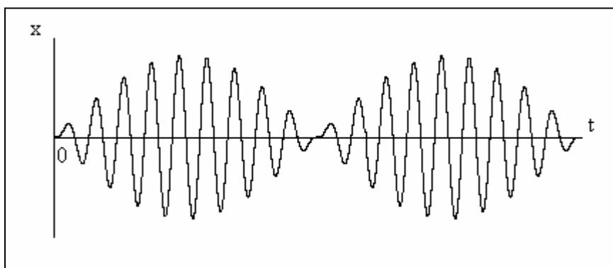
Рис. 3.29. График вынужденных колебаний при  $\omega_B = 0,9 \omega_0$  (биение)
