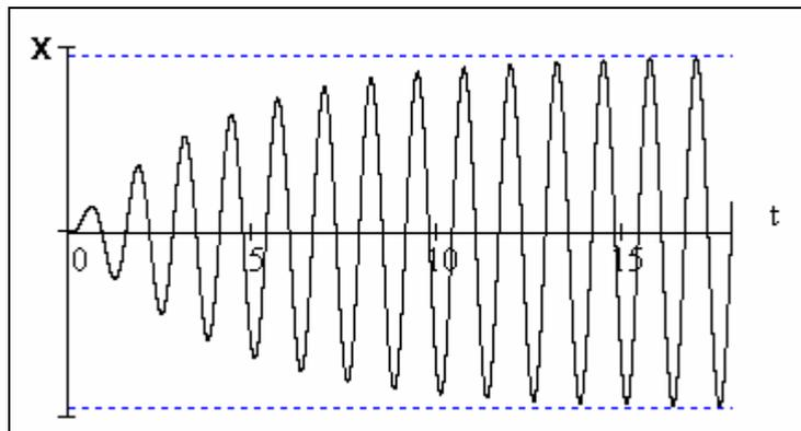
Рис. 3.30. График движения точки при резонансе и наличии силы сопротивления
