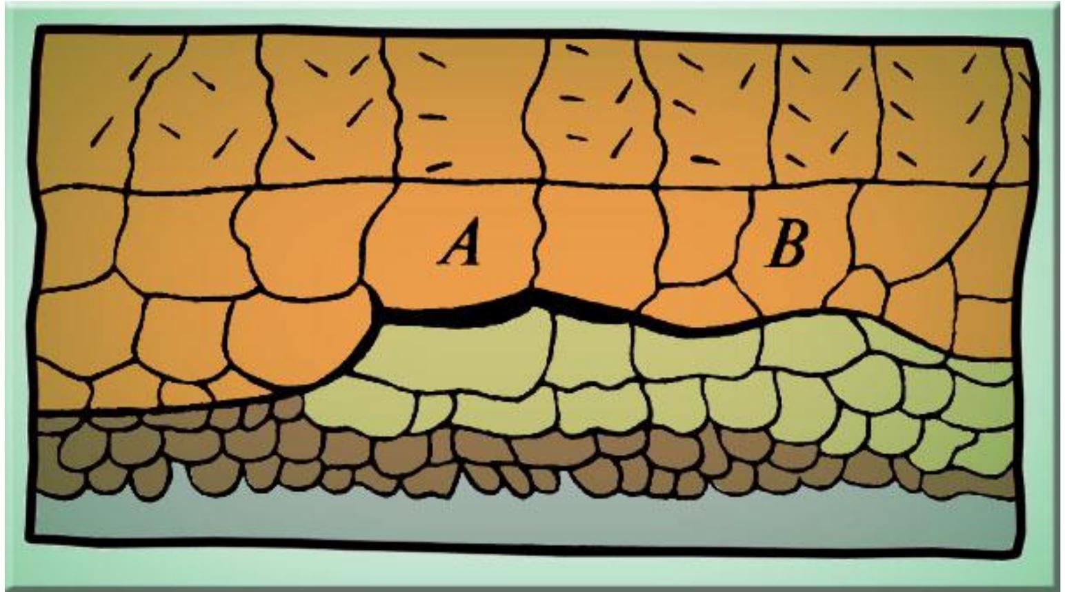
*Рис. 20. Межкристаллитный характер разрушения на участке очага холодной трещины (А) и смешанной на участке ее развития (В)*
