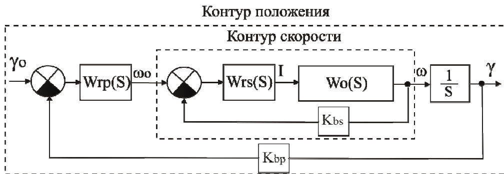
Рис. 7.3. Структурная схема системы управления шаговым двигателем
