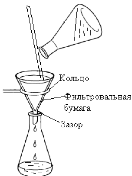
Рис. 31 Правильное расположение воронки и приемника
