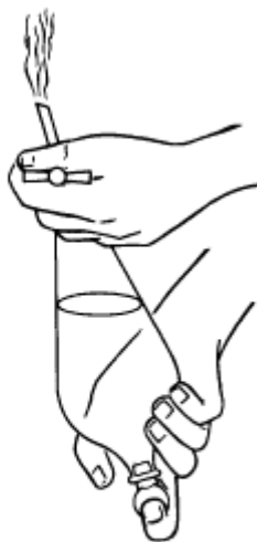
Рис. 50 Работа с делительной воронкой
