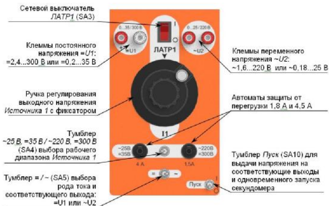
Рис. 1.2. Источник 1 с описанием функциональных элементов
