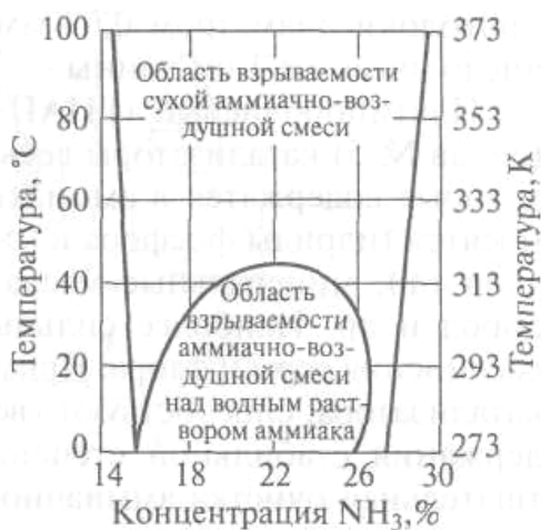
Рис. 2.21. Пределы взрываемости аммиачно-воздушной смеси
