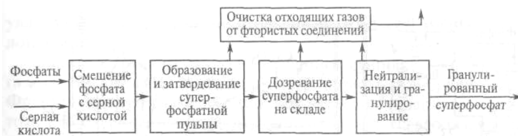
Рис. 3.11. Функциональная схема производства простого суперфосфата
