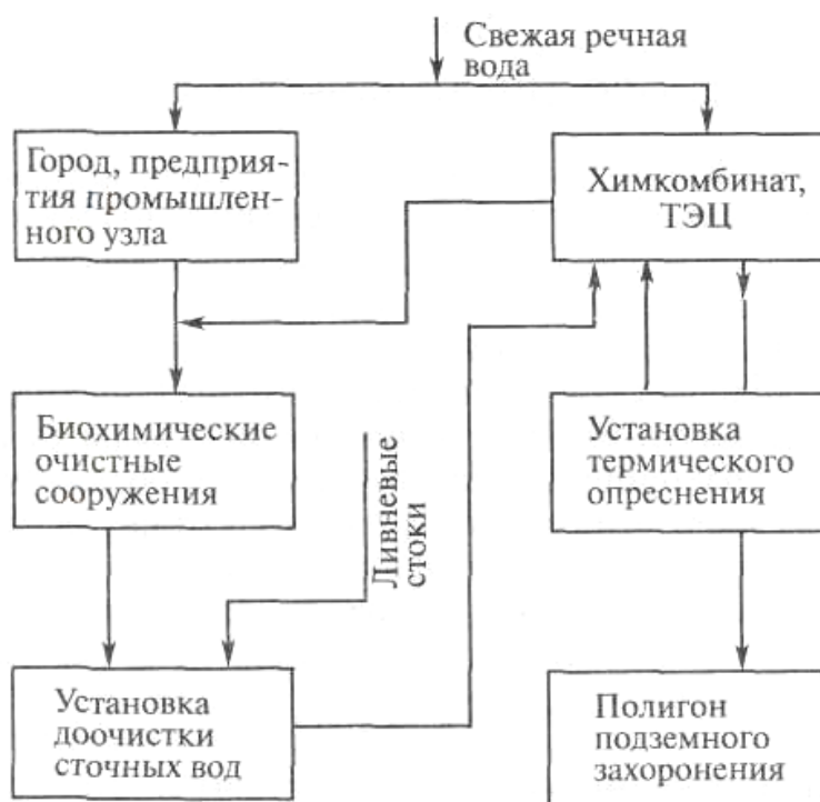
Рис. 1.11. Структурная схема водопотребления Первомайского химического комбината
