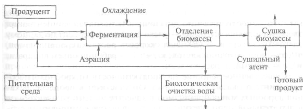
Рис. 6.1. Функциональная схема получения биомассы
