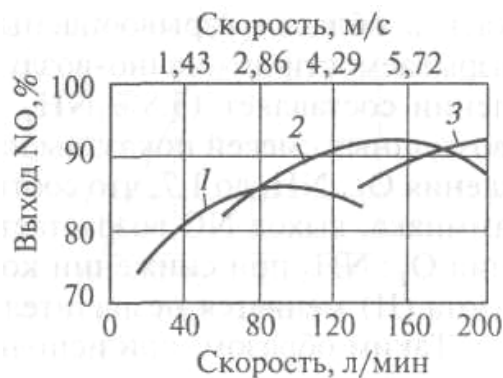
Рис. 2.20. Зависимость выхода оксида азота от скорости газа и числа сеток при давлении 1,96 МПа и температуре 900 °С:
