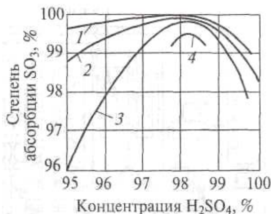
Рис. 3.9. Зависимость степени абсорбции \text{SO}_3 в моногидратном абсорбере от концентрации \text{H}_2\text{SO}_4 при температурах: 1 – 60 °С; 2 – 80 °С; 3 – 100 °С; 4 – 120 °С
