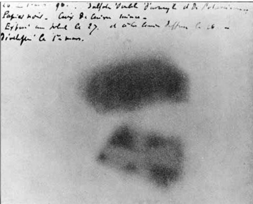
Изображение фотопластинки Беккереля, засвеченной излучением солей урана (1896 г.). Видна тень металлического мальтийского креста, помещённого между пластинкой и солью урана.
