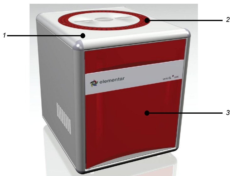
Рис. 17. Вид закрытого прибора спереди: 1 – Верхняя крышка прибора; 2 – автоподатчик образцов (автосэмплер, карусель) на 120 позиций; 3 – передняя дверца прибора
