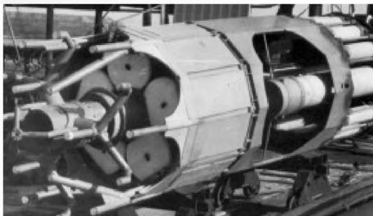
Буровой наконечник диаметром 2 м
