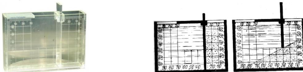
Рис. 22.2. Малый прибор для определения угла естественного откоса песчаных грунтов при закрытой и выдвинутой створке
