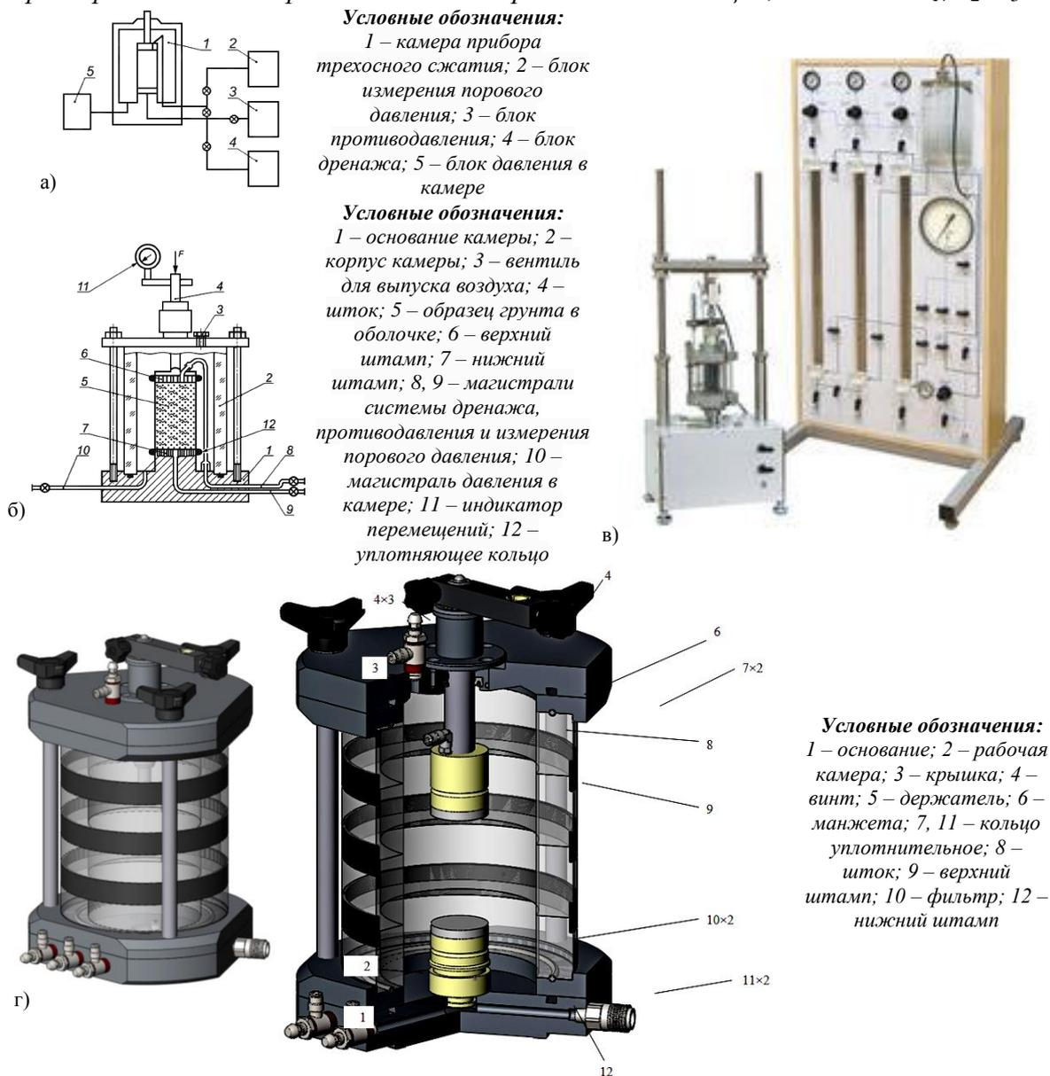
Рис. 37.2. Приборы трехосного сжатия: а) блок-схема установки для трехосных испытаний грунтов, б) схема камеры трехосного сжатия, в) установка трехосного сжатия и г) камера трехосного сжатия типа А конструкции ООО «НПП Геотек»
