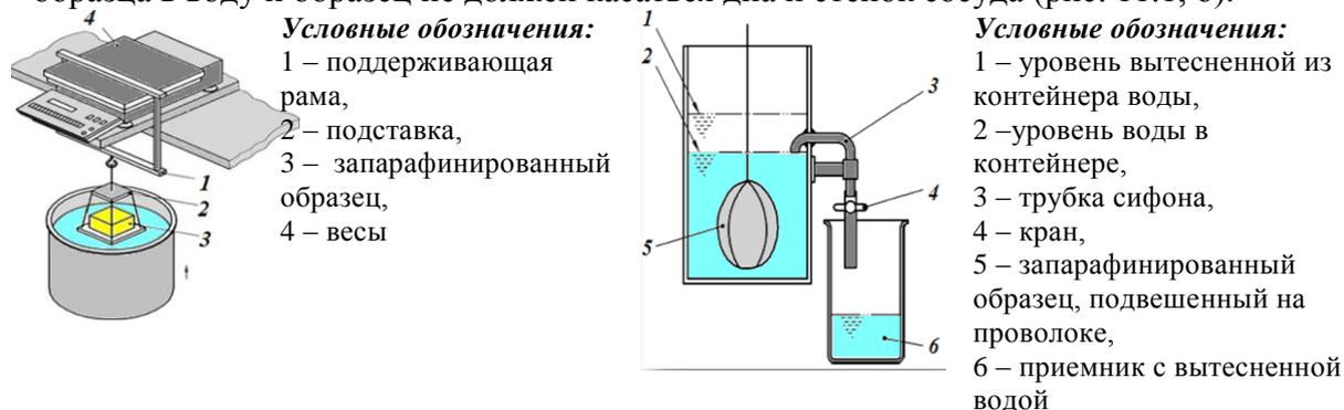
Рис. 11.1. а) взвешивание образца на электронных весах, б) погружение образца в жидкость
