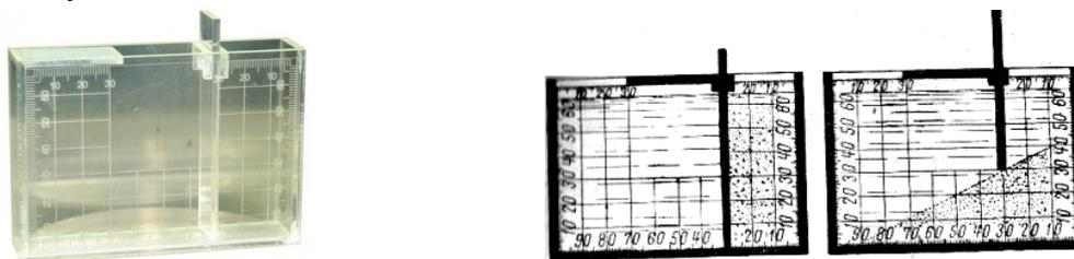
Рис. 22.2. Малый прибор для определения угла естественного откоса песчаных грунтов при закрытой и выдвинутой створке
