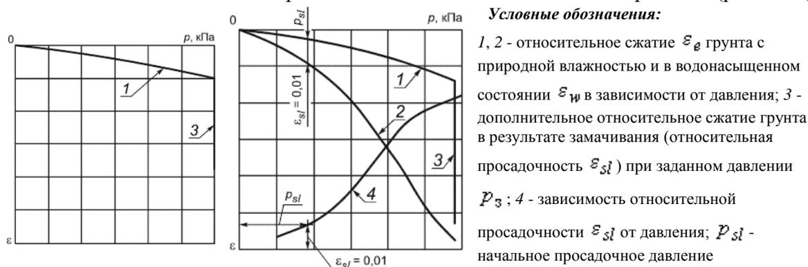
а) по схеме "одной кривой"    б) по схеме "двух кривых"
