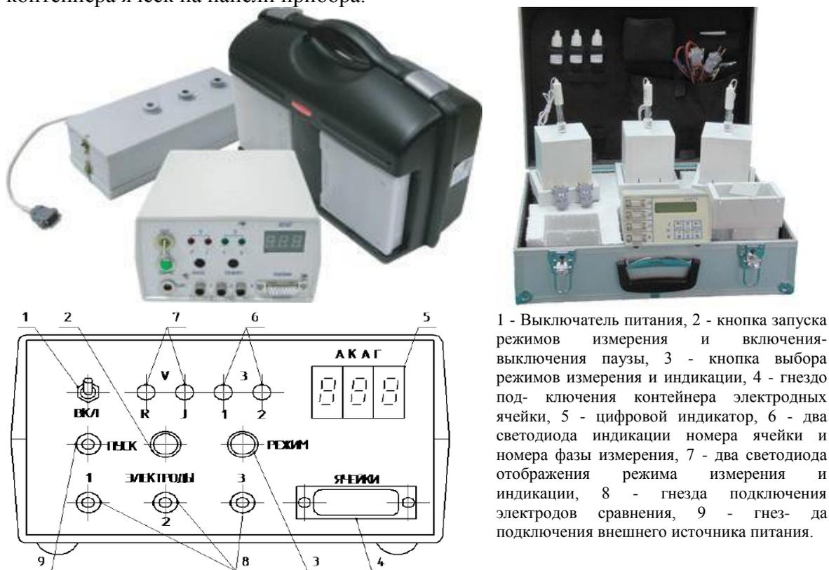
1 - Выключатель питания, 2 - кнопка запуска режимов измерения и включения-выключения паузы, 3 - кнопка выбора режимов измерения и индикации, 4 - гнездо подключения контейнера электродных ячейки, 5 - цифровой индикатор, 6 - два светодиода индикации номера ячейки и номера фазы измерения, 7 - два светодиода отображения режима измерения и индикации, 8 - гнезда подключения электродов сравнения, 9 - гнезда подключения внешнего источника питания.
