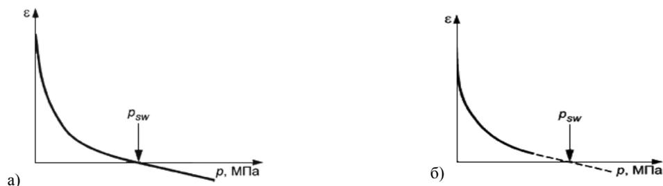
Рис. 31.1. график зависимости относительных деформаций набухания от вертикального давления  $p_{sw}$  а) установленное значение давления набухания; б) предполагаемое значение давления набухания
