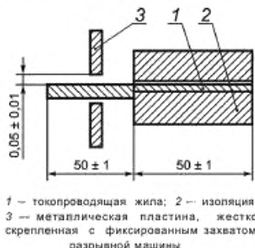
Рисунок 18 — Схема устройства для испытания на адгезию
