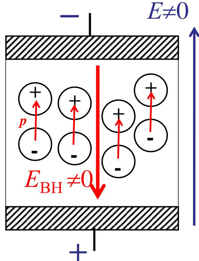
Система, состоящую из электродов, между которыми находится диэлектрик и к указанным электродам подводится напряжение
