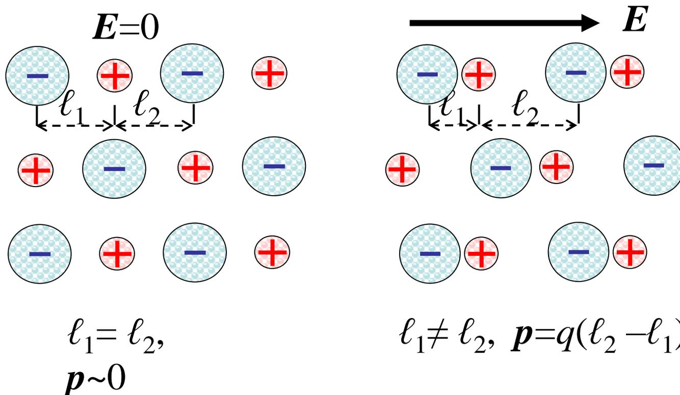
Упругое смещение связанных ионов из положений равновесия на расстояния, не превышающие постоянную кристаллической решетки.
