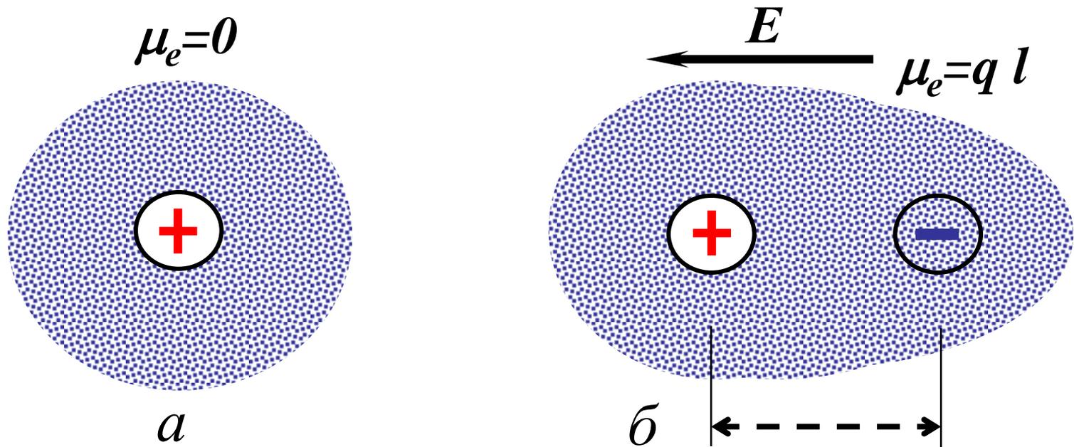
Смещение центра заряда электронного облака относительно положительно заряженного ядра под действием внешнего эл. поля.
