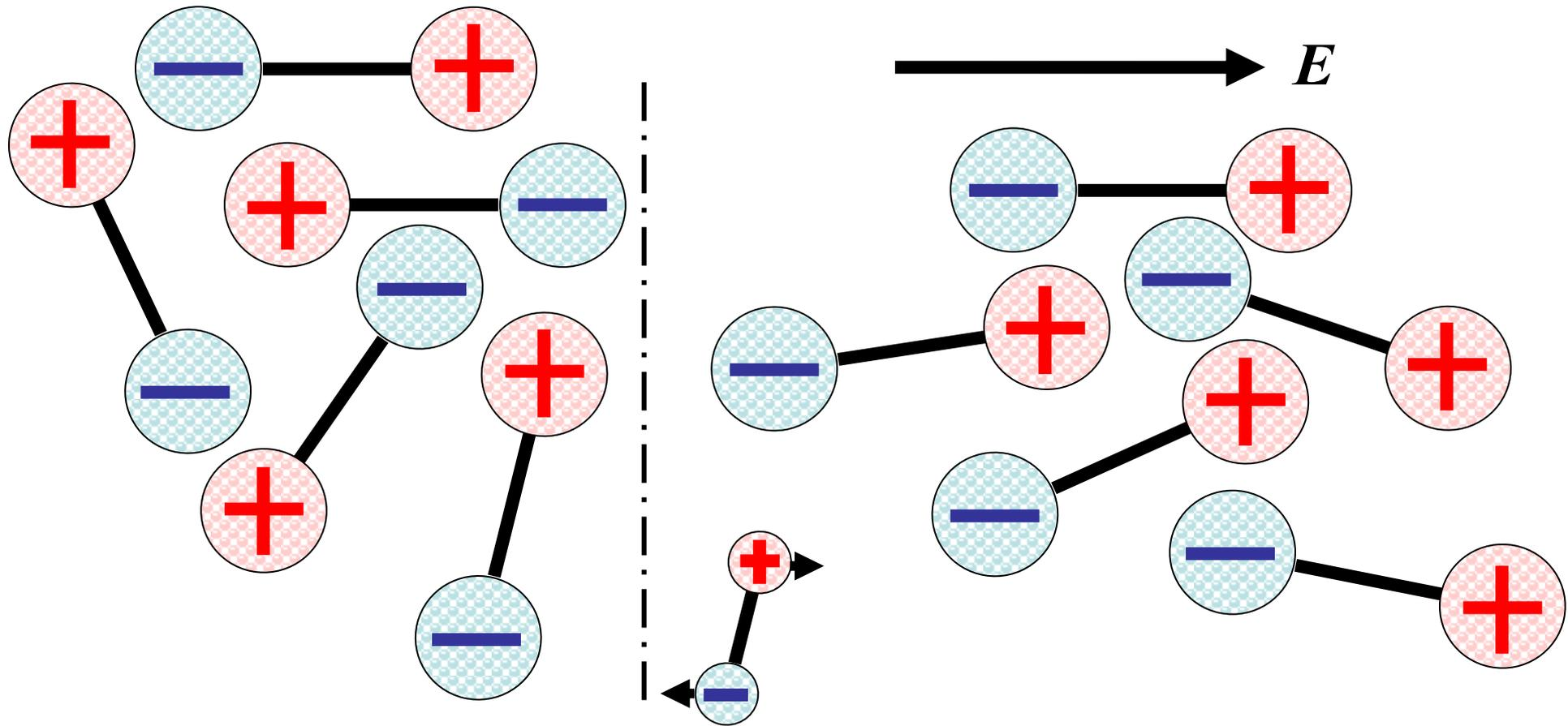
Заключается в повороте (ориентации) дипольных молекул в направлении внешнего электрического поля.
