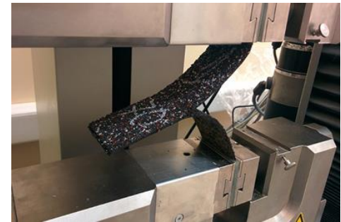
Испытание прочности клеевого соединения на разрыв на разрывной машине
