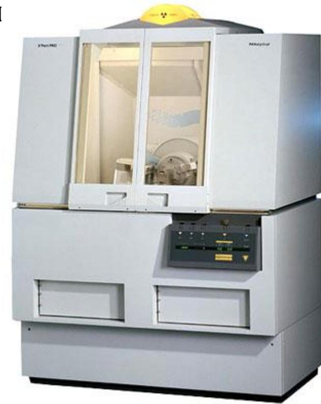
Наиболее распространенным (в первую очередь из-за своей доступности) является дифракция характеристического рентгеновского излучения. Для получения такого излучения используют рентгеновские трубки разного типа, в которых разогнанные до энергии порядка 40 кэВ электроны бомбардируют мишени (аноды) из различных металлов (наиболее распространены аноды из Cu, Co, Fe, Cr и Mo). Это приводит к появлению характеристических спектров излучения.
