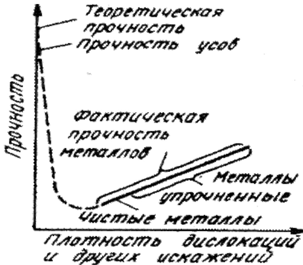
Рис. 2. Влияние искажений кристаллической решетки на прочность кристаллов. Левая ветвь кривой соответствует созданию совершенных бездислокационных нитевидных кристаллов (так называемых «усов»), прочность которых близка к теоретической.
