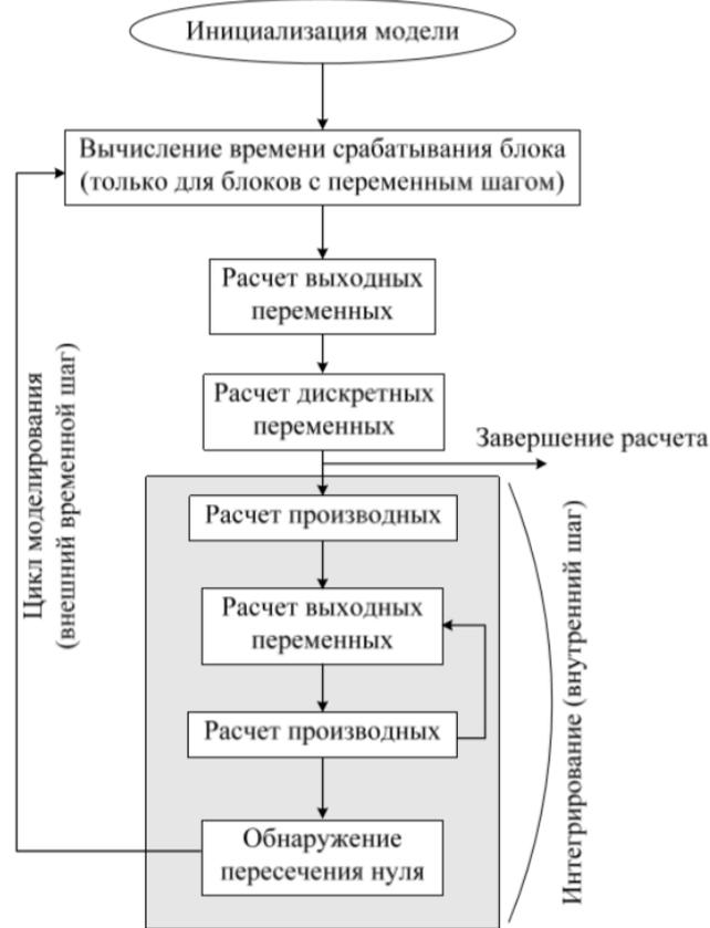
Рис. 3. Диаграмма, иллюстрирующая процесс моделирования
