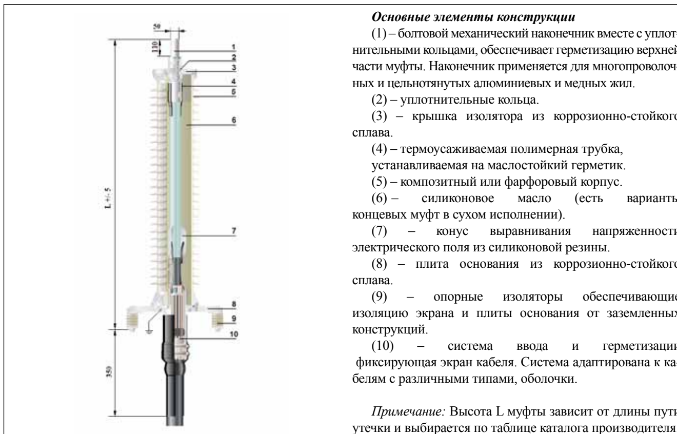
Рис.3.2 Основные элементы конструкции
