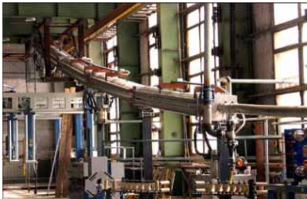
Рис. 1.5 – Производственный процесс- линия наложения изоляции Maillefer EPL 50 (Финляндия)
