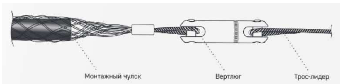
Рисунок 9 – Схема захвата кабеля
