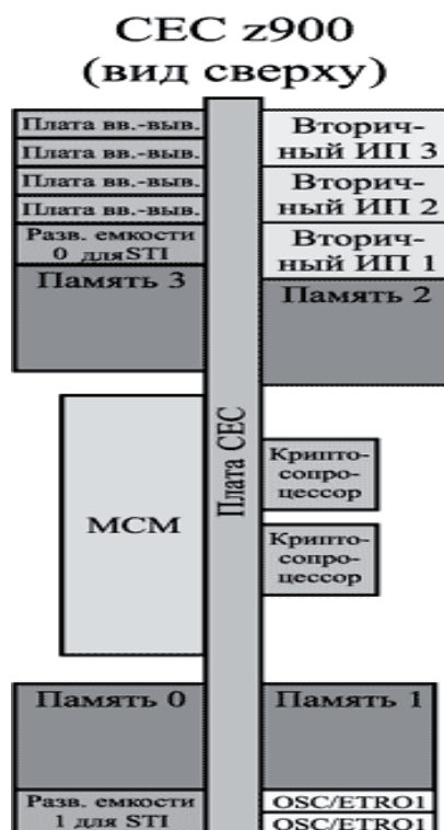
Рис. 6.9. Конструкция печатного узла СЕС z900
