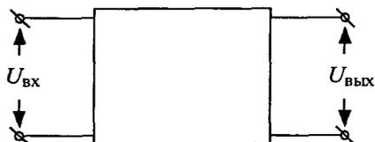
Рис. 8.2. Усилитель в виде четырехполюсника
