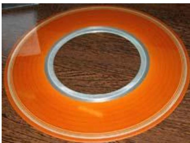
Пластина дискового запоминающего устройства
