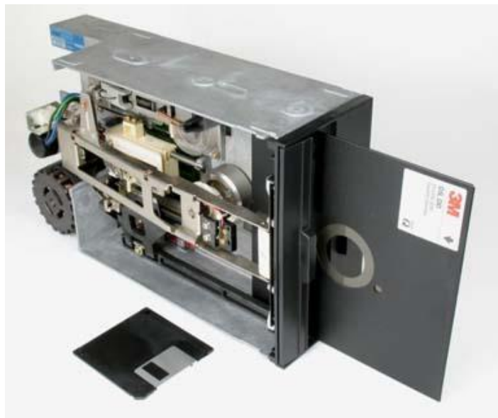
Накопитель на гибком магнитном диске (сравнение 8-дюймовой дискеты и дискеты 3,5 дюйма)
