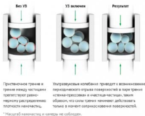
Рисунок 4- Метод ультразвукового компактирования
