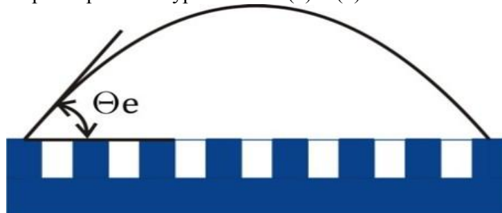
Рисунок 3 – Капля жидкости на микроструктурированной поверхности
